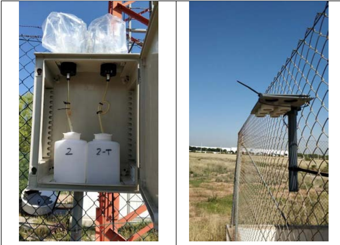
EFE-11. Colectores de deposición (izq.) y dosímetros pasivos (der.) para evaluar la deposición total en los colectores y la deposición seca como gases de diversos compuestos nitrogenados. El objetivo es conocer cuánto N se deposita en los ecosistemas de estas dos formas. Imágenes del Valle del Palancia.
