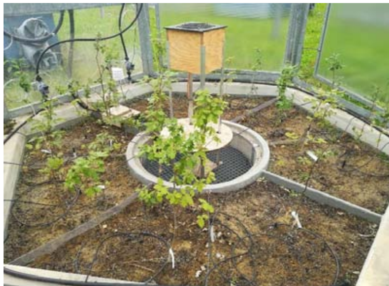
FOR-11. Instalaciones de cámaras climáticas en el WSL-Birmendorf donde se evalúa el efecto de las condiciones de sequía edáfica o sequía ambiental en plántulas de haya y roble.
