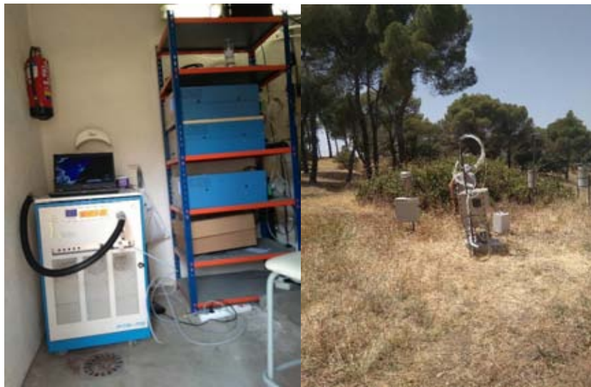
Figura EUPH-4. Instrumentación utilizada en la campaña Crisol. Izquierda: PTRMS y monitores, derecha: captadores activos automáticos.
