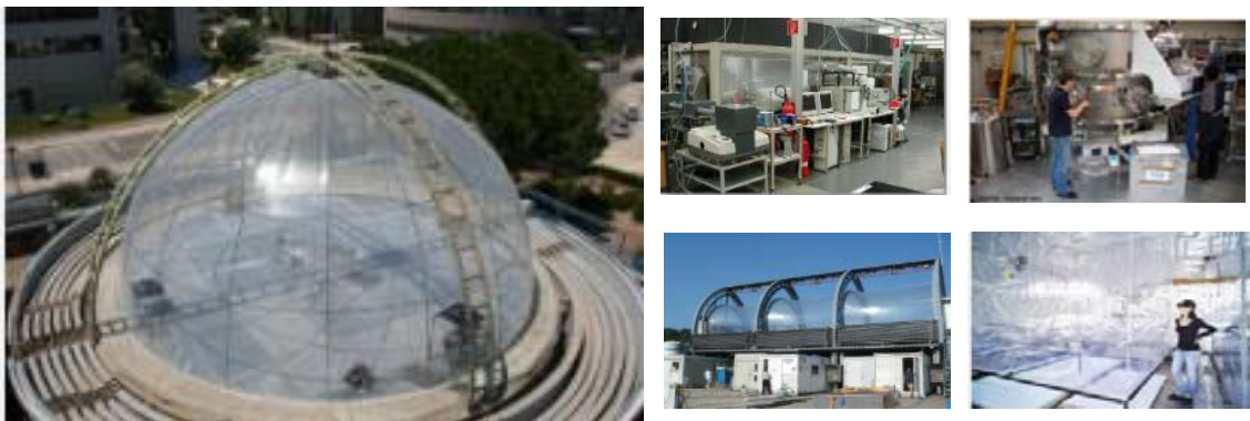
Figura EUPH-2. Algunas cámaras de simulación europeas. A) Cámara de simulación EUPHORE, de 200 m 3 , de teflón, forma semiesférica y que usa luz solar. B) Cámara QUAREC de cuarzo, forma cilíndrica de 1 m 3 y radiación artificial (Universidad de Wuppertal, Alemania). C) Cámara CESAM, de acero inoxidable 4,2 m 3 , forma cilíndrica y radiación artificial (CNRS-LISA, Francia) D) Cámara SAPHIR, de teflón, forma cilíndrica de 260 m 3 y luz solar (FZJ, Juelich, Alemania), E) Cámara PACS-C3, de teflón, forma de cubo de 27 m 3 (PSI, Suiza).
