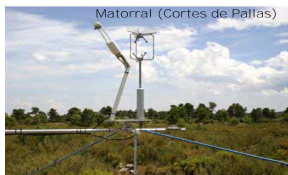
EFE-1. Estaciones de medidas de flujos de CO 2 y H 2 O operadas por la Fundación CEAM.
