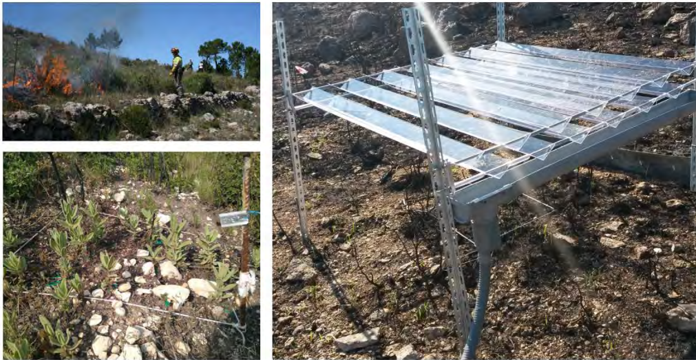
Figura FOR- 4. Realización de la quema experimental en ecosistemas dominados por especies germinadoras obligadas (arriba izquierda). Estructura de exclusión de lluvia para la simulación de periodos de sequía postincendio (derecha). Plántulas establecidas en las parcelas experimentales dos años después del incendio.
