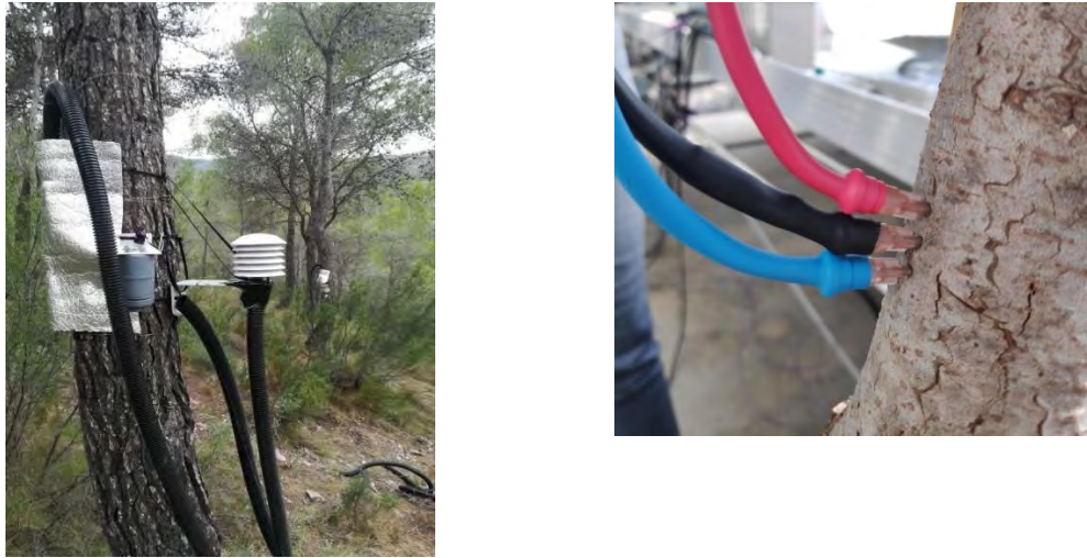
Figura FOR- 12. Imagen de una parcela en clima semiárido con los sensores de sap-flow protegidos en el tronco y los sensores de variables climáticas. Detalle de las sondas sap-flow insertadas en el tronco de uno de los individuos del experimento de calibración del método HRM.
