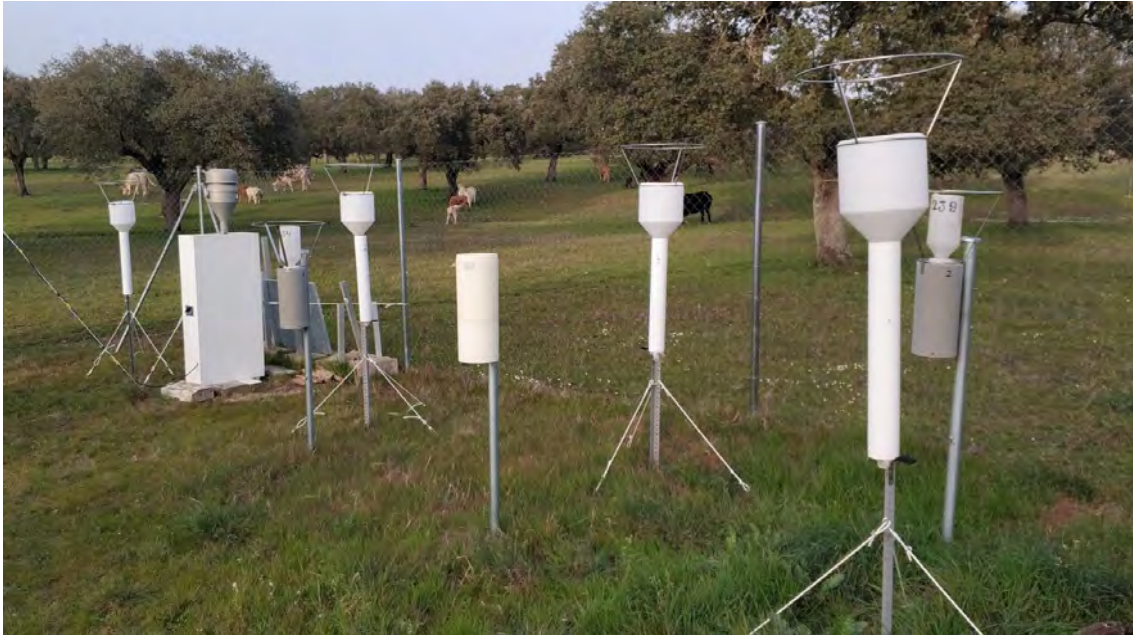
EFE-10. Colectores de deposición en la estación experimental de Majadas de Tiétar, utilizados para estudiar la deposición de compuestos nitrogenados.
