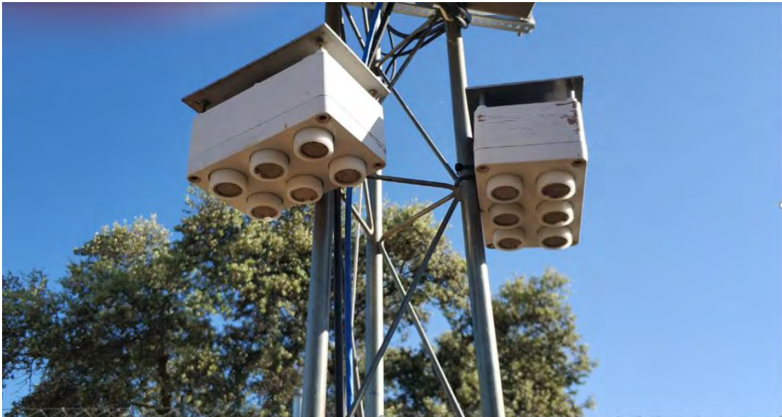
EFE-11. Dosímetros pasivos utilizados en las parcelas de Nivel II del ICP-Forests
