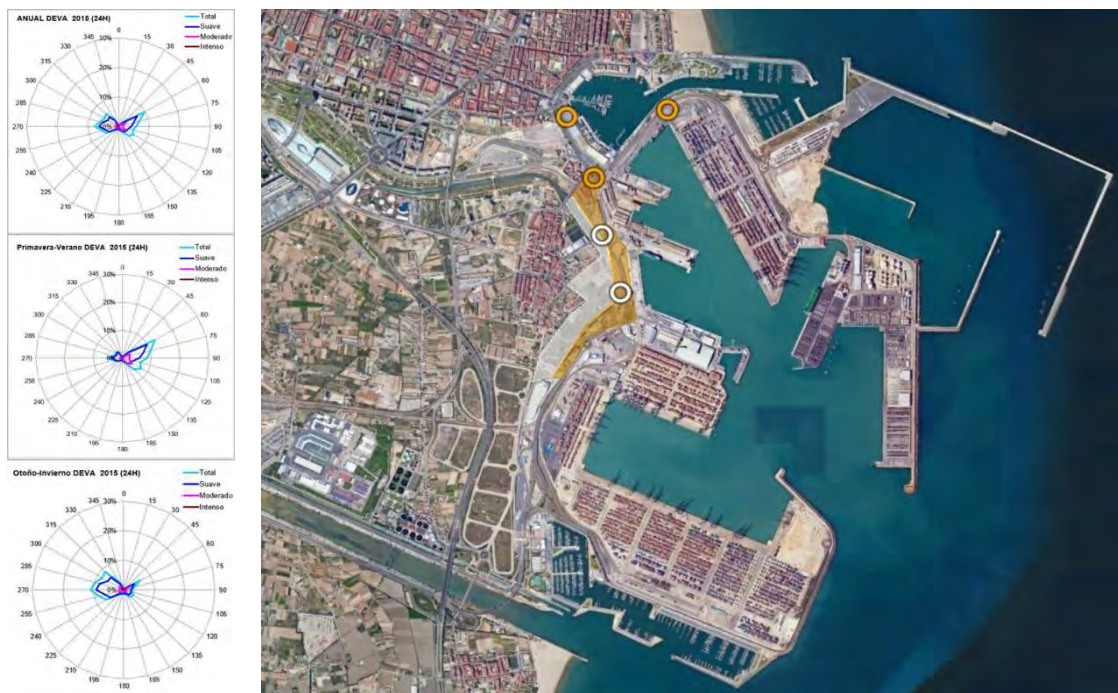
Figura DIN-2. Rosas de viento representativas de la aerología de la zona y propuesta de posibles emplazamientos para las dos nuevas estaciones de medidas de la calidad del aire del Puerto de Valencia
